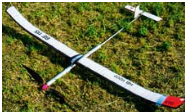
Die Technik des Freiflugs: Dieses F1B-Modell, entworfen und gebaut von Rudolf Trumpf, MG Bern, besteht hauptsächlich aus Carbon- und Aramidfasern. Es besitzt einen Verstellpropeller, und der eingebaute Zeitschalter steuert im Verlauf des Flugs fünf Funktionen
